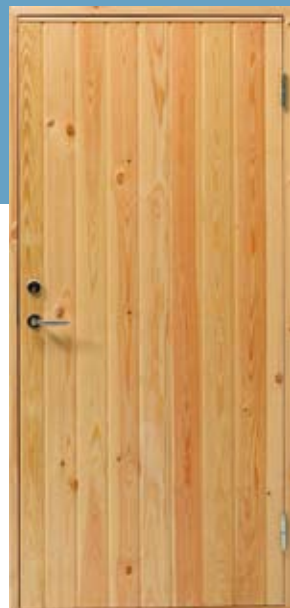
458 Mõõdud: 9 X 21 Viimistlusvalmis mänd Komplekti kuuluvad ukseleht, leng sügavusega 93mm, reguleeritavad hinged, lukukorpus, lävepakk, tihend
